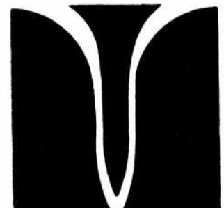
Fig. 29. — Courbe épaissie obtenue lors des réglages des transfos MF. Augmenter la capacité entre le point "V" et le châssis ou placer une bobine de choc en série avec la connexion aboutissant à la douille « tension à mesurer » de l'oscillographe.
